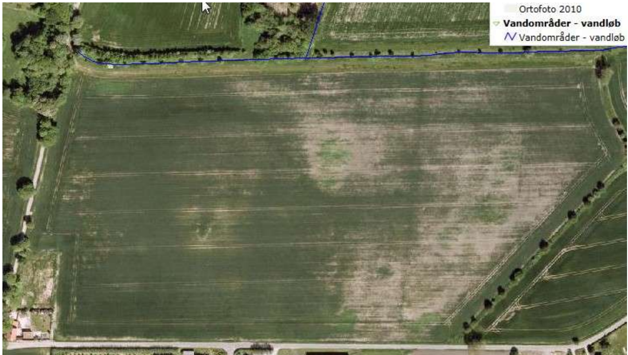
Figur 5.7: Den ”usynlige” skade. Højbunds lerjordsareal ved Ringe Å, Skamby. Afgrøden er ødelagt på grund af vandmætning, som følge af sedimentation i dræn. Sedimentationen skyldes utilstrækkelig vandløbsvedligeholdelse. Usynligt, set fra jorden. Usynligt, hvis ikke man er sagkyndig. Meget tabsvoldende, og ødelæggende for konkurrenceevne og miljø. Ødelæggende for arealets dyrkningsværdi.
